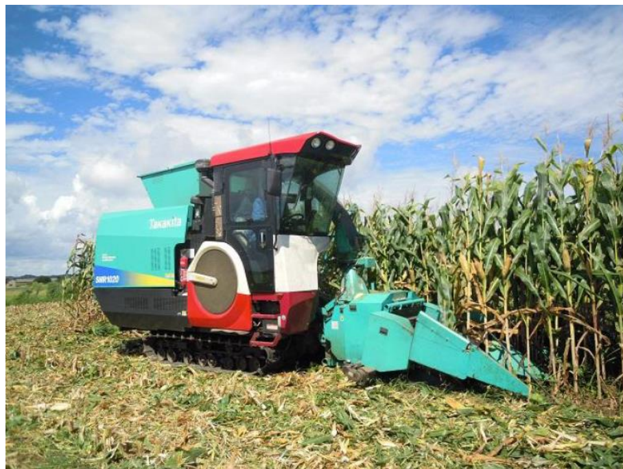
図2 汎用型飼料収穫機とスナッパヘッドによるイアコーンの収穫作業風景
