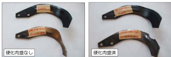
摩耗比較試験（約40ha使用）
